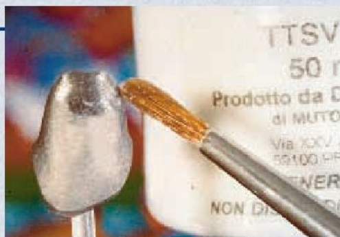
L'applicazione della sostanza gelatinosa per il primo trattamento di inertizzazione sotto stato vetroso.
